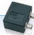
Преобразователь интерфейсов коакс/витая пара (балун) BE-1 позволяет подключать любое оборудование E1, оснащенное несимметричным интерфейсом для коаксиального кабеля, к витой медной паре вместо более дорогостоящего коаксиального кабеля. Конвертер BE-1 позволяет подключать аппаратуру E1 или ISDN, оснащенную симметричным интерфейсом для витой пары, к существующим коаксиальным кабелям.
