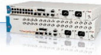
Optimux-34 и Optimux-25 предоставляют простое и недорогое решение для передачи трафика множественных каналов E1 или T1, а также последовательных данных и трафика Ethernet на расстояния до 110 км.
