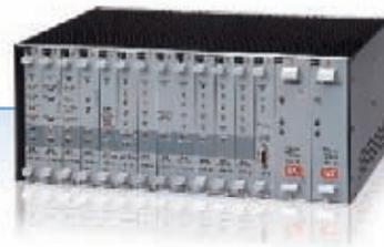
LRS-24 - управляемая система доступа RAD для решения задач «последней мили» с помощью широкого спектра технологий, скоростей, интерфейсов и сред передачи. Система поддерживает стандартные технологии типа G.703 и SHDSL.
